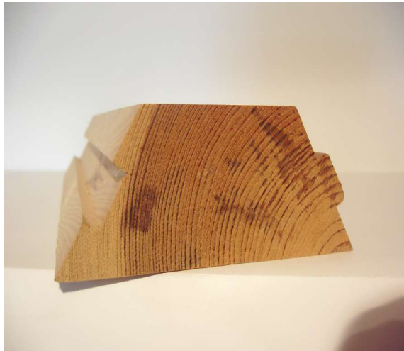
Nut und Feder 60 ° Verbindung
