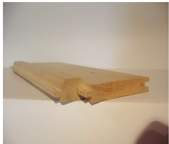
Außenschalung mit Stab
